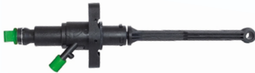
AP4570 Cód. Original 46754822 / 55222435 Cilindro maestro de embrague Pico diámetro 9,5mm Varilla plástica
